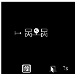
После регулировки параметров и подтверждения ввода данных появляется следующий экран. Будет предложено подтвердить данные в течение следующих 7 секунд. В этом случае: «Проверка герметичности, активированная после завершения рабочего цикла горелки».
