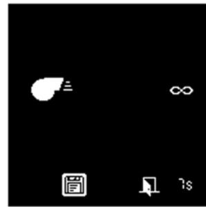
Es necesario confirmar esta activación. Para ello, aparece la pantalla que se ilustra a la izquierda (Manual Handshake). La ventilación permanente se mantiene activada durante todo el preajuste en el menú 1. Al final del menú 1, se desactiva.
