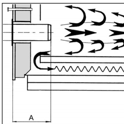
En caso de calderas con chimenea ciega, debe respetarse la profundidad de penetración mínima **A** del tubo de llama siguiendo las indicaciones del fabricante de la caldera.
