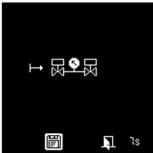
La pantalla siguiente aparece después del ajuste de los parámetros y la validación de la introducción de los datos. El sistema solicita validar los datos en un plazo de 7 segundos. En este caso: "Control de estanqueidad activado después del ciclo del quemador". Abajo a la derecha aparece en pantalla un contador que indica el tiempo restante.
