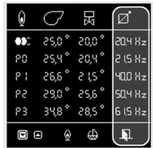
В отличие от режима работы без преобразователя частоты нужно выполнить настройку дополнительного канала во время настройки в меню 1. Канал для преобразователя частоты можно настроить и изменить точно так же, как это описано для топливных каналов и воздушной заслонки в разделе «Меню 1. Настройка серводвигателей».
