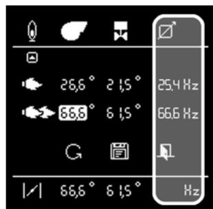
В заводских условиях горелка настроена так, чтобы частота двигателя могла регулироваться в диапазоне 25...50 Гц. Значение, которое отображается справа внизу экрана, является параметром возврата. Оно соответствует базовому значению. Возможны незначительные отклонения от базового значения.
