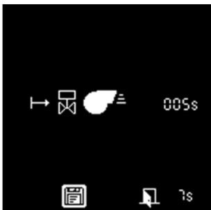
Al aceptar los valores, aparece una segunda pantalla. En este caso: "Tiempo de postventilación activado, duración 5 segundos." El sistema solicita validar los datos en un plazo de 7 segundos.
