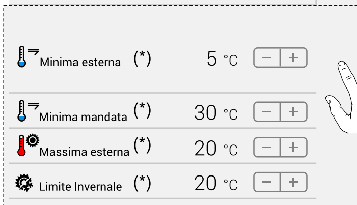
График внешней компенсации - Т макс. 70°C - Т наруж. от 5°C до 20°C - Т мин. 30°C
