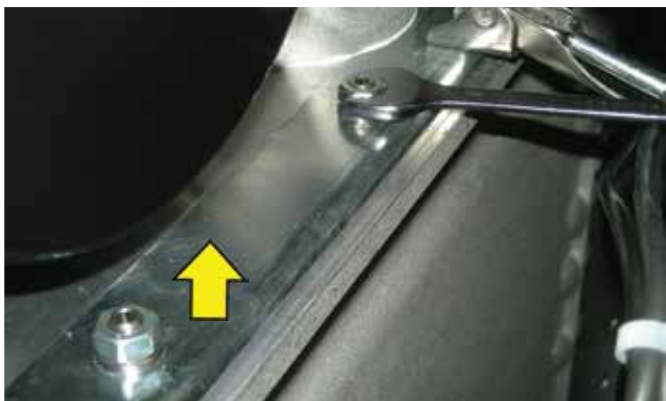
- Снимите винты "В" (при помощи торцевого ключа 13 мм / гаечного ключа 13 мм) и снимите крепежные пластины
