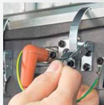
"Быстрое снятие" системы сгорания
