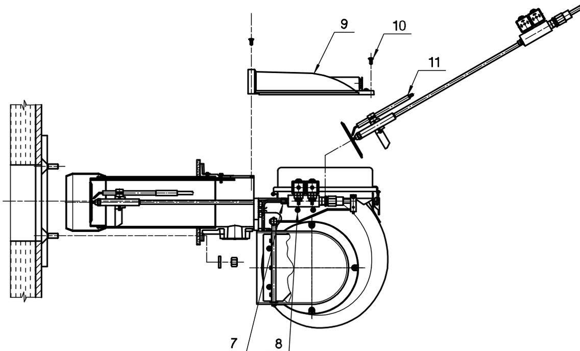
Fig. 12 ИЗВЛЕЧЕНИЕ СМЕСИТЕЛЬНОЙ КАМЕРЫ
