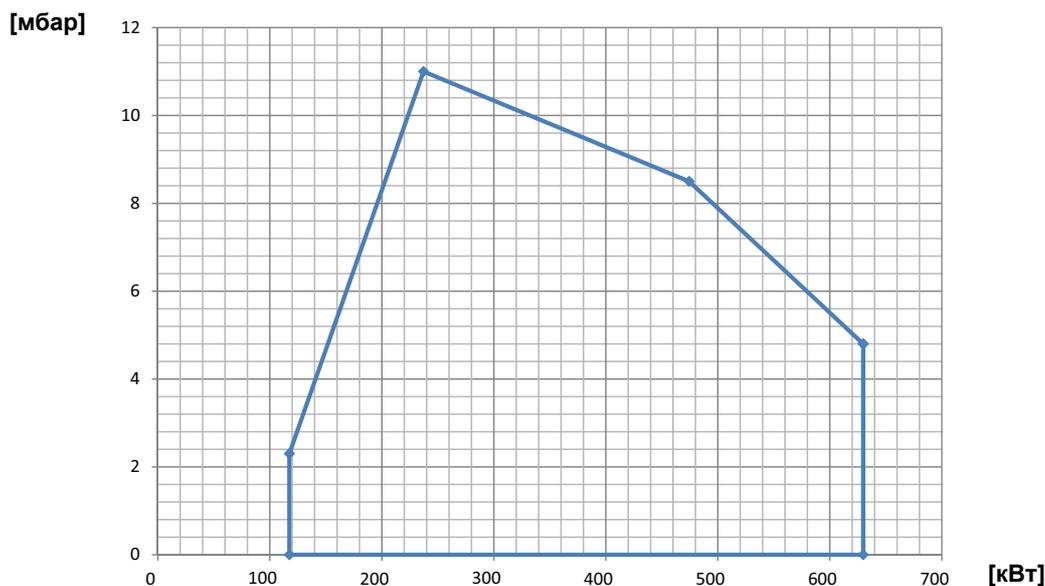
Fig. 1 X = Мощность Y = Соппротивление камеры сгорания
